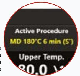
In base al prodotto selezionato, il programma seleziona automaticamente la procedura di prova da utilizzare per il provino
